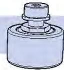
헵코의 HRR 트랙롤러는 58~122 규격의 경우에는 복열 볼 베어링을, 144 규격에는 트윈 롤러 베어링을 사용하며, 이들 모두는 높은 방사상 하중용량을 제공한다. 트랙롤러는 간단히 조립이 가능한 디자인으로, 스크류 하나로 시스템에서 분리도 쉽도록 고안되었다. 각각의 트랙롤러에는 화학적으로 흑색색 된, 고강력 스틸 저널 및 부쉬가 있으며, 동심과 편심(조정형) 형태로 이용 가능하다. 모든 트랙롤러는 블라인드 또는 관통 홀 고정 타입으로 이용 가능하며, 스테인리스 스틸 버전도 표준형으로 이용 가능하다
