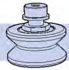
모든 베어링은 최대의 수명을 위해 윤활이 되어있으며, 액체 및 이물질 침투 방지를 위해 니트릴(Nitrile) 씰드 처리 하였다. 하지만, 베어링과 슬라이드 사이 접촉면에 협곡의 캡 와이퍼나 윤활기를 사용하여 슬라이드나 베어링의 V면에 윤활을 해줄 것을 권장한다. 이렇게 할 경우, 하중용량과 수명이 상당히 증대된다.
