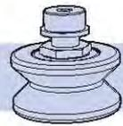
애플의 HJR 베어링은 64~128 규격의 경우에는 복열 볼 베어링을, 150 규격에서는 트윈 테이퍼 롤러(twin taper roller) 베어링을 사용하며, 이들 모두는 높은 축 및 방사상 하중용량을 제공한다. 베어링은 간단히 조립이 가능한 디자인으로, 스크류 하나로 시스템에서 분리도 쉽도록 고안되었다. 각각의 베어링에는 화학적으로 흑색색 된, 고장력 스틸 저널 및 부쉬가 있으며, 동심과 편심(조정형) 형태로 이용 가능하다. 모든 베어링은 블라인드 또는 관통 홀 고정 타입으로 이용 가능하며, 스테인리스 스틸 버전도 표준형으로 이용 가능하다.
