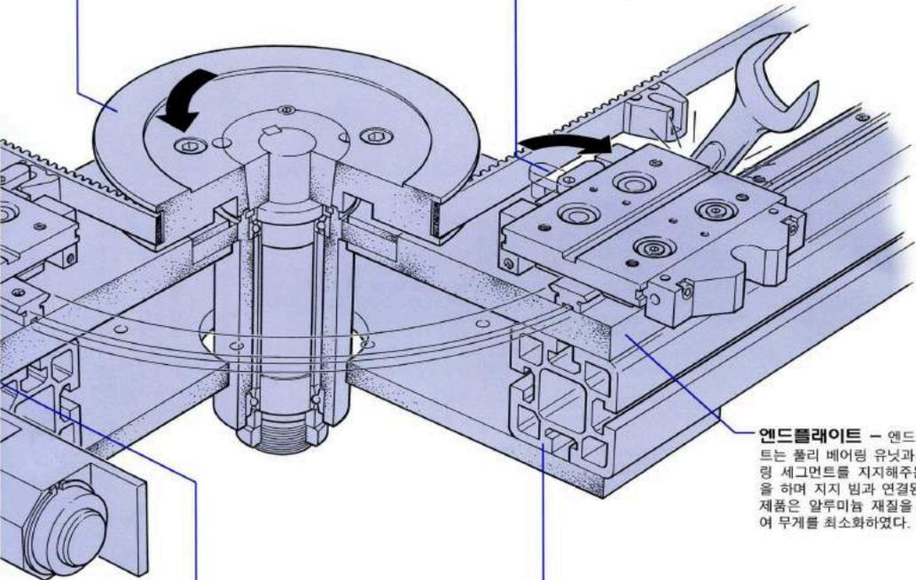
**센서 설치 브래킷(울선사양)** - 센서 설치 브래킷은 직선 구간 중 어느 곳에든지 취부가 가능하며, M8 나사산의 근접 스위치(공급 안됨)와 맞추어 사용 가능하다.
